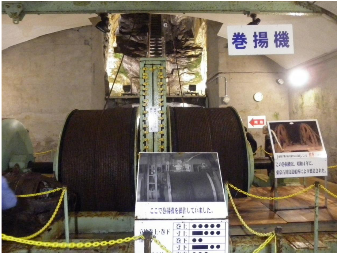
↑鉱山内を行き来する巨大なエレベーターの巻き上げ機
